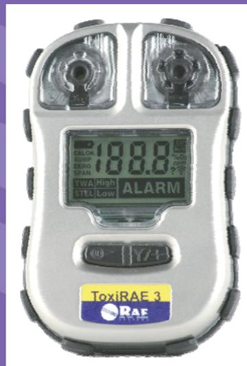
ToxiRAE 3 单一毒气检测器体积小、外形时尚、性能可靠，除可持续显示有毒气体浓度外，还可显示 STEL 值、TWA 值、峰值，以及电池剩余寿命、标定提示等信息，单独设置高 / 低浓度和 STEL/TWA 报警限值，可用于有毒有害环境工作人员的防护。产品外壳选用不锈钢材料。两键式操作，简单易行。仪器的标定同样也十分简便。根据实际情况选择使用或调整预设报警下限，以满足个性化需求。可广泛应用在钢铁冶金、工业安全等方面。
